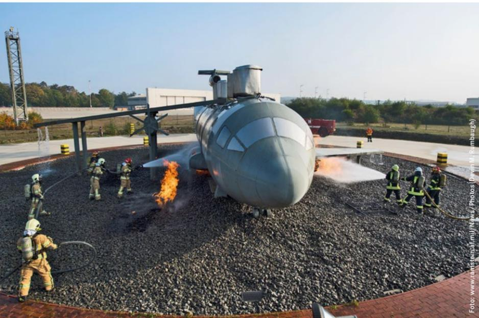
*Feuerlöschung auf der US Air Base Ramstein. Hierbei wird Kerosin – in diesem Fall der krebserregende NATO-Treibstoff JP-8 – in den Boden versenkt, der mit einer Kiesschicht abgedeckt ist. Anschließend wird dieser Treibstoff angezündet und der Boden mit einer Schaumschicht belegt.*
